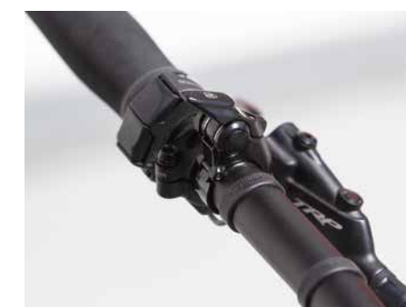
Volič příslušný motoru Shimano vzdáleností ovládacích tlačítek nedonutí palec k velkým pohybům, u Authora je na dosah i zamykání vidlice
