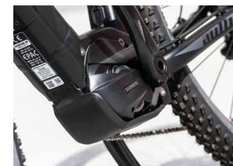
Motor je umístěn horizontálně, jeho přední část je blíže terénu, kryt zde má důležitou funkci
